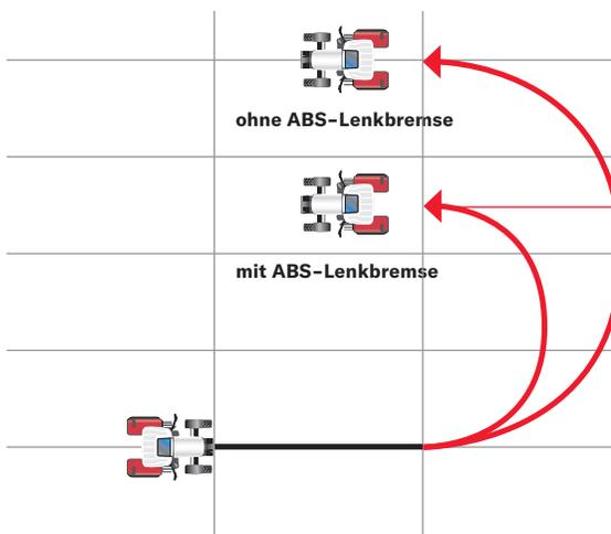
Die automatische ABS-Lenkbremse sorgt für einen verkleinerten Radius.
