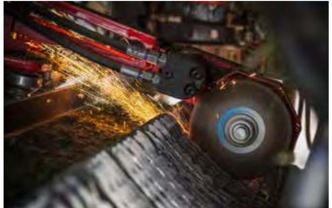
Ein exakter, gleichmäßiger Schnitt ist die Grundlage für beste Silagequalität. AUTOCUT sichert eine dauerhafte Schnittqualität über einen ganzen Arbeitstag. Die Messerschleifeinrichtung AUTOCUT ermöglicht eine komfortable Schärfung der Messer direkt am Ladewagen.
