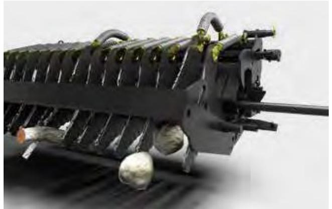
Die Messer sind aus gehärtetem Werkzeugstahl und der Wellenschliff sichert einen exakten Schnitt. Mit TWIN BLADE Wendemessern erreichen Sie die doppelte Standzeit da Sie immer ein Ersatzmesser mitführen: Auch dies ist einzigartig bei Pressen.
