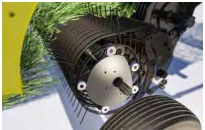
Die PÖTTINGER Pick-up wird beidseitig über Kurvenbahnen aus Stahl gesteuert.
