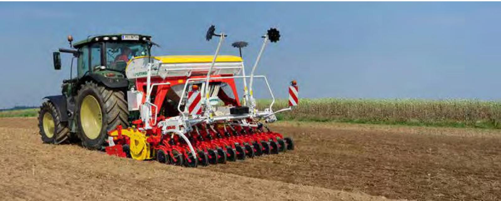
Das einzigartige AEROSEM Sämaschinen-Konzept von PÖTTINGER vereint die Aussaat von Getreide und Mais. Die präzise arbeitende, universelle Dosierung und die perfekten Scharsysteme garantieren ein exaktes Ablegen des Saatgutes.
