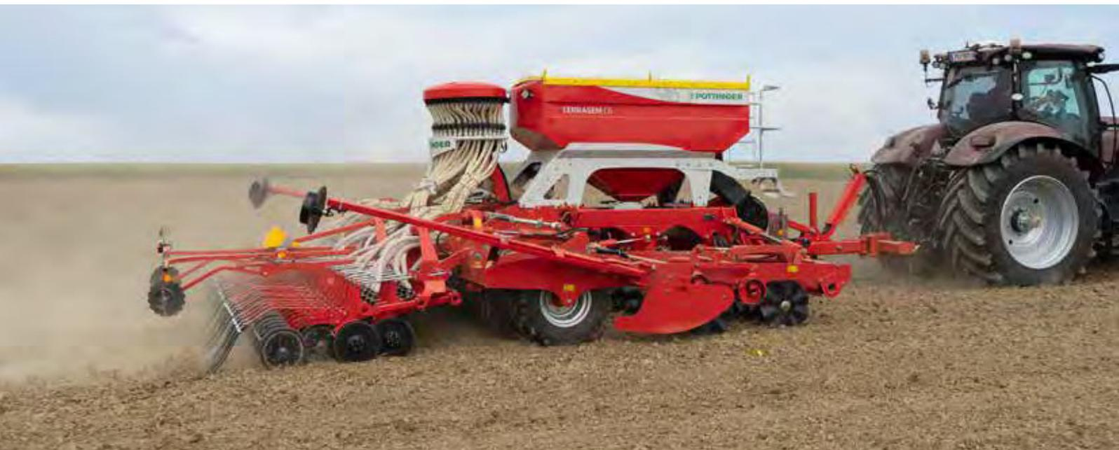
Die wartungsfreien WAVE DISC Wellscheiben haben einen Durchmesser von 510 mm und sind mit einem Reihenabstand von 12,5 cm oder 16,7 cm verfügbar. Die Arbeitstiefe kann wie beim WAVE DISC System stufenlos hydraulisch verstellt werden. Das PÖTTINGER WAVE DISC System ist ideal geeignet für schwierige Bodengegebenheiten, welche eine reduzierte Bodenbearbeitung notwendig machen. Die Wellscheiben WAVE DISC sind für alle TERRASEM Mulchsaatmaschinen erhältlich.
