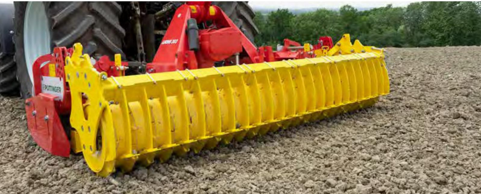
Intensives Zerkleinern für beste Krümelung und gute Durchmischung sind die Vorzüge der PÖTTINGER Kreiselegger. In Kombination mit einer PÖTTINGER Sämaschine entsteht ein schlagkräftiges und wirtschaftliches Gespann für eine perfekte Aussaat.
