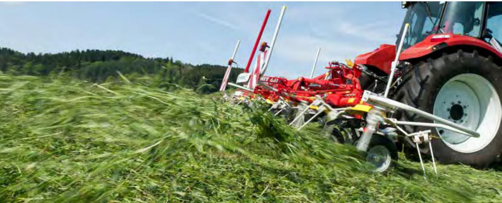
Unsere bewährten Zettkreisel überzeugen durch perfekte Boden Anpassung. Dies ermöglicht Ihnen futterschonendes Zetten ohne Schmutzeintrag. Die breiten Räder, in Verbindung mit dem MULTITAST Rad am Anbaubock, verbessern die Hangtauglichkeit deutlich. Die hohe Verarbeitungsqualität garantiert eine lange Lebensdauer.
