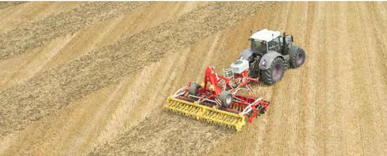
Das Zwischenfrucht-Säggregat TEGOSEM kombiniert die Bodenbearbeitung und die Ausbringung von Zwischenfrüchten in einem Arbeitsschritt, und sorgt so für Zeit- und Kostenersparnis. Die TEGOSEM ist sowohl mit LION Kreiseleggen, mit FOX Kurzkombinationen, mit TERRADISC Scheibeneggen, als auch mit SYNKRO Grubbern kombinierbar. Der Einsatz des Säggregates ist auf Dreipunktmaschinen und gezogenen Maschinen möglich.
