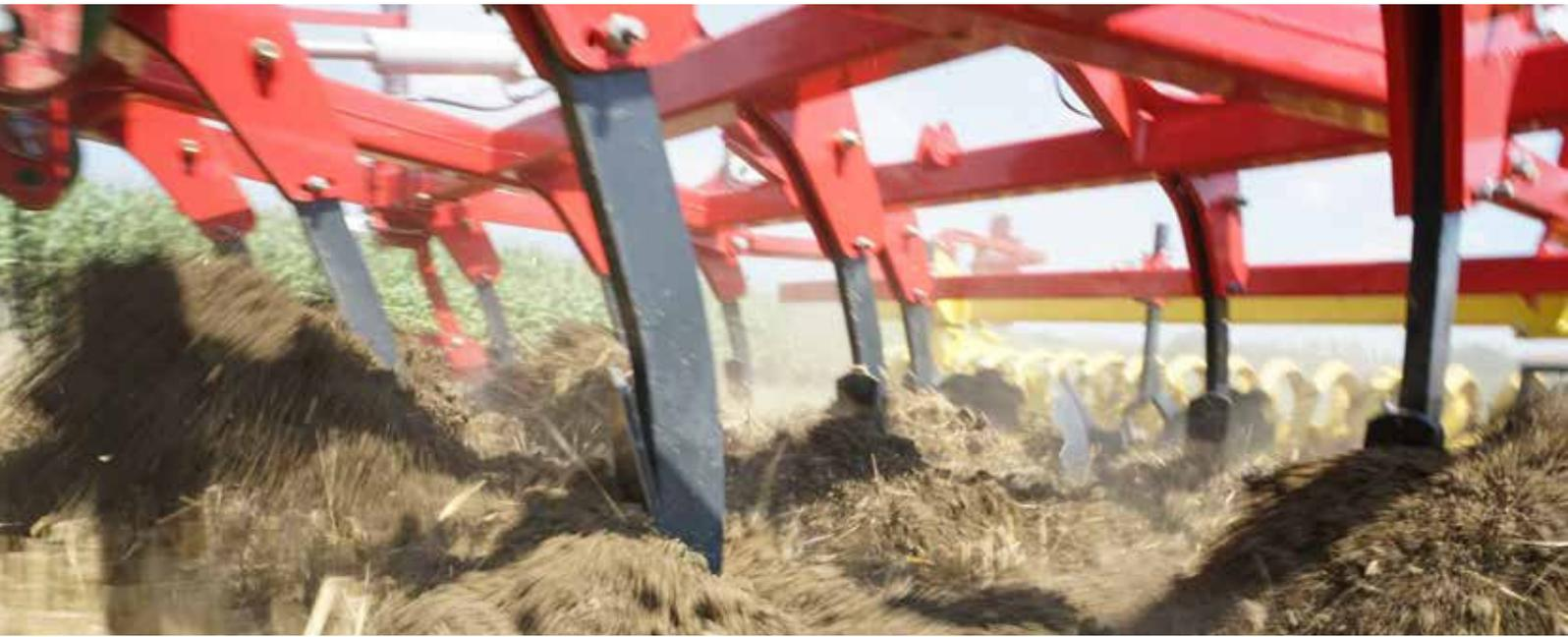
Die PÖTTINGER SYNKRO Grubber wurden für den zeitgemäßen Stoppelsturz entwickelt und eignen sich für die flache als auch tiefe Bodenbearbeitung. Bei der Konstruktion wurde besonders auf Leichtzügigkeit und geringen Kraftbedarf geachtet.
