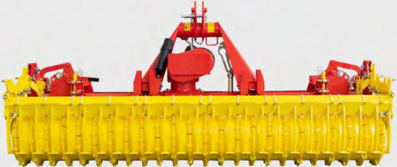
Je nach Bodentyp bietet PÖTTINGER ein breit gefächertes Nachläufer-Programm für ein perfektes Arbeitsergebnis mit der gewünschten Krümelstruktur. Das gesamte Walzenprogramm zeichnet sich durch exakte Verarbeitung und robuste Bauweise aus.
