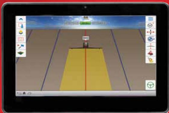
**XCN 2050 DISPLAY.** Erstmals kommt ein Multi-Touch-Bediensystem zum Einsatz, das eine komfortable Bedienung per Fingertipp ermöglicht. Durch das Android-Betriebssystem kann auch zusätzliche Software installiert und damit der Funktionsumfang erweitert werden – von landwirtschaftlichen Anwendungen wie Lichtbalkenanzeigen, Wetterdaten und Niederschlagswerten bis hin zu betriebsspezifischen Standort-Informationen.
