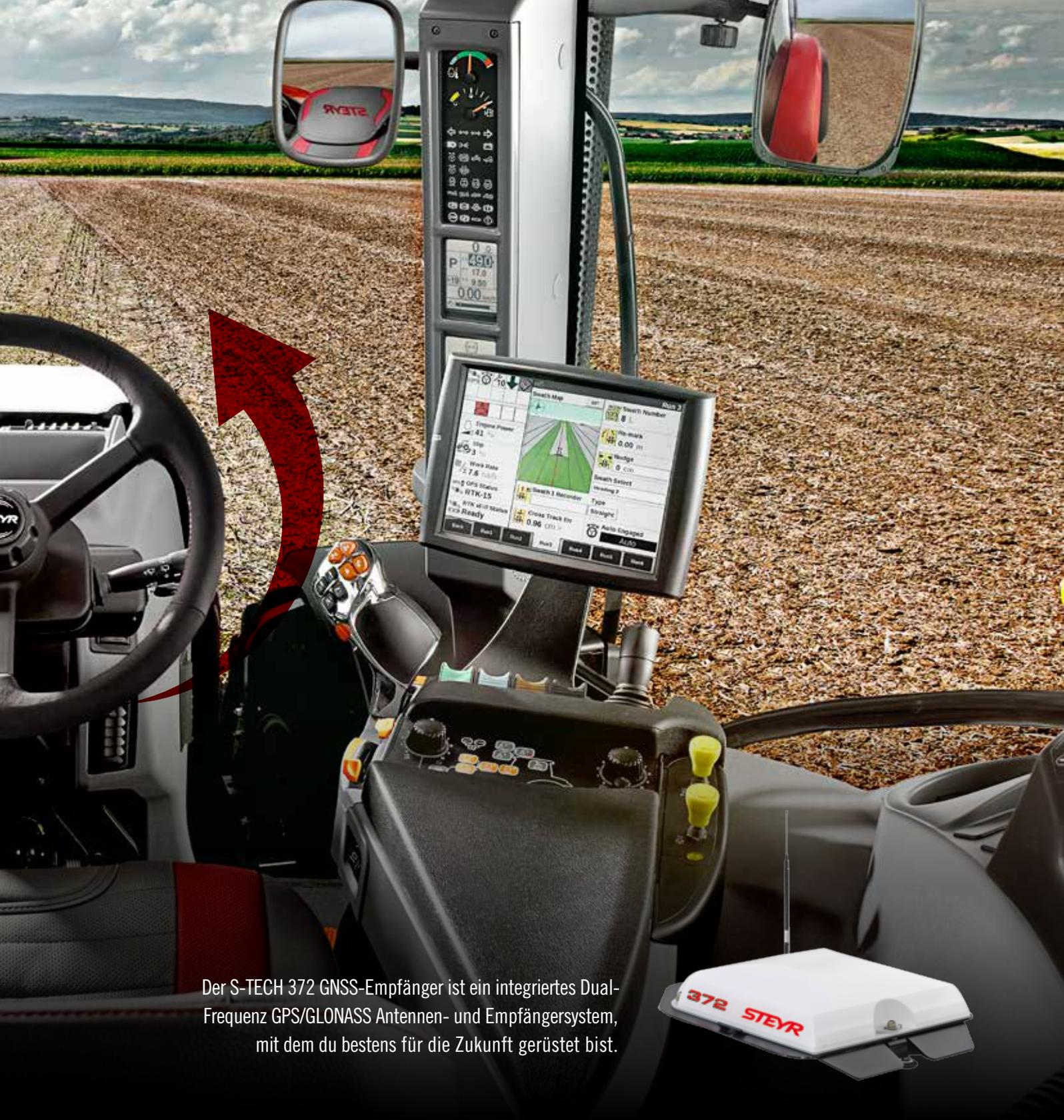
Der S-TECH 372 GNSS-Empfänger ist ein integriertes Dual-Frequenz GPS/GLONASS Antennen- und Empfängersystem, mit dem du bestens für die Zukunft gerüstet bist.
