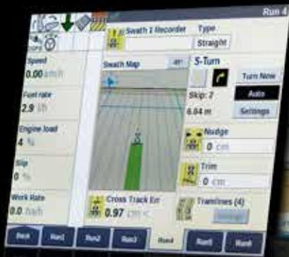
S-Turn wendet automatisch am Ende der Fahrspur
